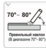
Качество сварки зависит в основном от опыта рабочего, от вида сварки и от качества электрода, поэтому выбирайте подходящий электрод до того, как приступите к сварке, учитывая толщину и состав свариваемых металлов. Сварочный процесс представляет собой сложный комплекс методов и приемов, различных технологий и правильного подбора материалов. Для получения качественных соединений необходимо пользоваться профильной литературой.
